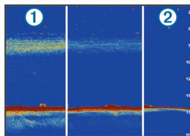
Растяжение эхосигнала и ширину фильтра можно использовать вместе для получения предпочитаемого разрешения и уменьшения шумов. При установке низкого значения для растяжения эхосигнала и ширины фильтра изображение на экране имеет высокое разрешение, но
