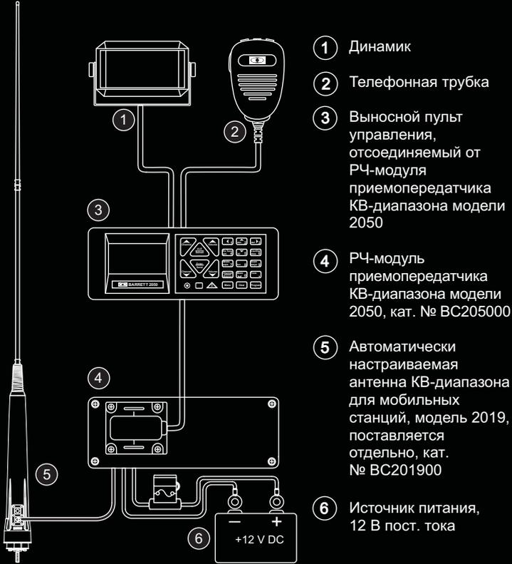
Пример типовой конфигурации приемопередатчика КВ-диапазона модели 2050 для базовой станции
