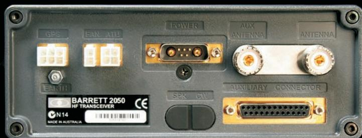
Задняя панель КВ-приемопередатчика модели Barrett 2050
