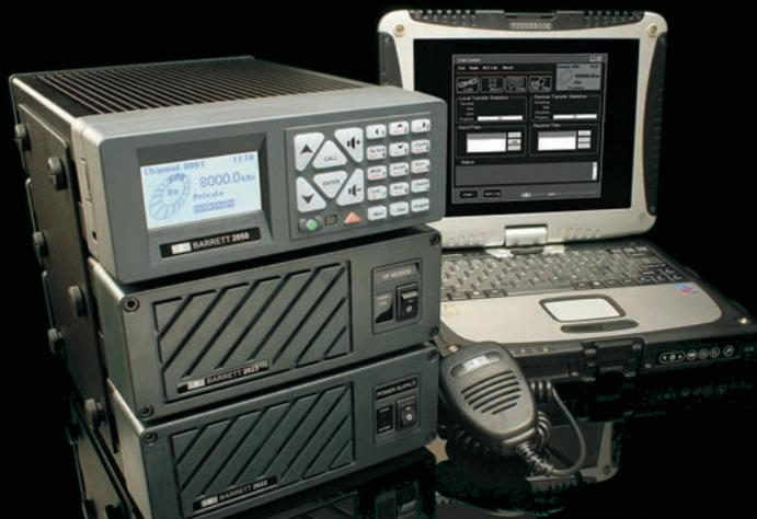
КВ-приемопередатчик Barrett 2050 с модемом 2023, блоком питания 2022 и портативным ПК с модулем Barrett 2020 для обмена факсимильными сообщениями и другими данными по электронной почте
