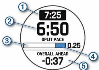
На устройстве отображается целевой темп на отрезке **1**, текущий темп на отрезке **2**, ход выполнения отрезка **3**, расстояние до конца отрезка **4** и общее время опережения или отставания от целевого темпа **5**.
