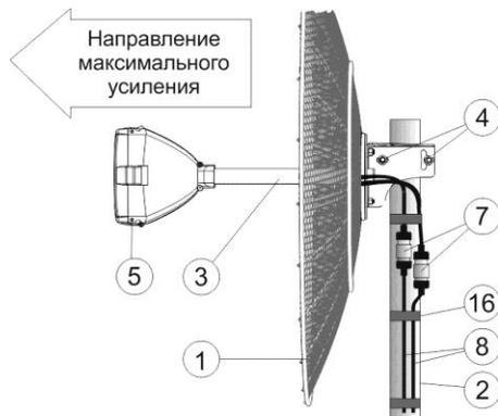
Рисунок 2 - Установка антенны на мачту
