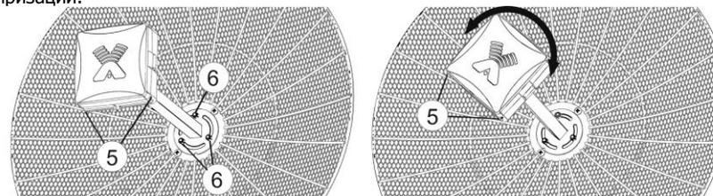
Рисунок 4 – Начальное положение облучателя с поляризацией V+H (слева) и X-pol (справа)
