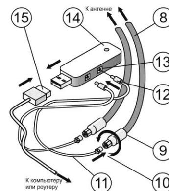
Рисунок 3 - Подключение модема
