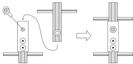
Рисунок 2. Сборка антенны.
