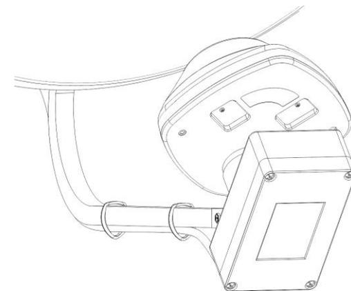
Рисунок 3 – Положение облучателя в держателе с поляризацией +/-45 градусов
