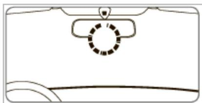
Если установка в центре невозможна, например, из-за наличия датчика дождя, можно установить устройство слева или справа от зеркала. Расположите устройство так, чтобы ничего не загораживало вид. После установки отрегулируйте и зафиксируйте устройство в горизонтальном положении для получения оптимального обзора
