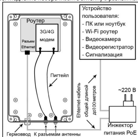
Схема 3 – Подключение PoE инжектора питания
