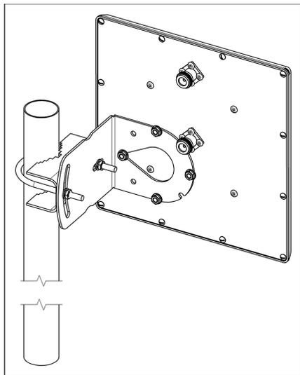
Рисунок 2 – Монтаж антенны на мачте
