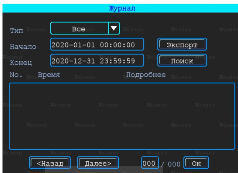
Доступны следующие значения: Все, Тревога, Исключения, Локал. настройки, Удал настройки, Настройка 3G, G-сенсор, Система(флэш). Все события журнала кроме событий типа - Система(флэш) записываются на носитель данных (SD карту, HDD/SSD диск). События типа Система(флэш) записываются во внутреннюю энергонезависимую флэш память видеорегистратора. Доступны 250 записей (при переполнении записей старые записи перезаписываются на новые).
