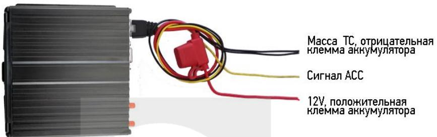
*Примечание: при тестировании устройства, подключите оба провода – красный и желтый провод с положительным полюсом источника бесперебойного питания, в противном случае устройство не загрузится.*
